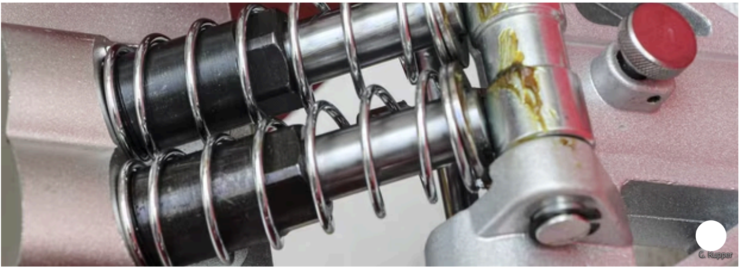
Holzmann RWH 125: wenig Pumparbeit dank Doppelkolbenpumpe.
